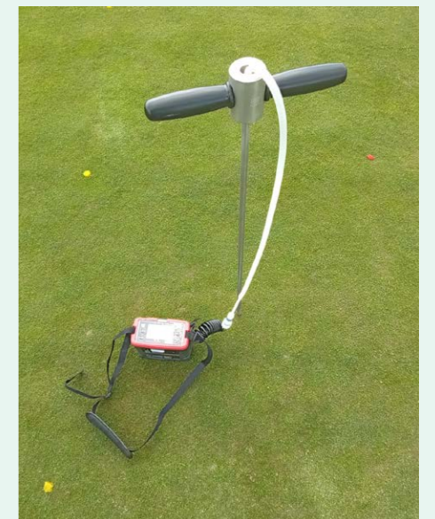
Figures 27 & 28: Mesure du niveau d'oxygène dans le sol (oxymètre de sol, Eijkelpamp) au Golf Club de Rigenee, mai 2023
